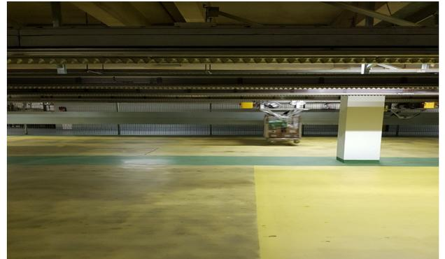
Spezialtransportanlage mit beladenem Fahrwerk
