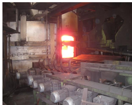
Hochofen erhitzt den Stahl auf 1.380°Grad
