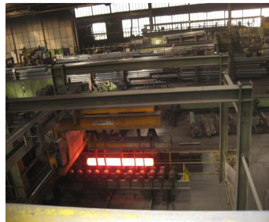
Glühender Stahl wird ins Planetenschrägwalzwerk eingeführt
